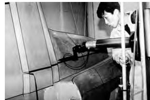
縮小モデルをベースに原寸モデルをつくり計測、CADデータ化
